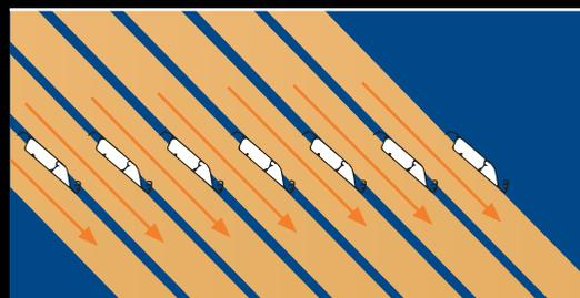
**En hiver** / un des avantages majeur de la pergola Solembra est de laisser entrer, la lumière à l'intérieur de la maison grâce à l'orientation de ses lames entre 150° et 160°. La réverbération du soleil sur les lames de votre pergola bioclimatique va permettre un ensoleillement maximum dans la pièce attenante. Fini le manque de lumière en hiver !
