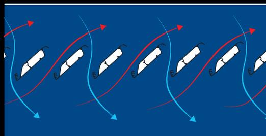
La pergola bioclimatique permet de créer une ventilation naturelle en évitant l'effet «véranda». Avec les lames entrouvertes, la chaleur est évacuée et l'air frais est piégé sous la pergola, tout en procurant une ombre totale au-dessous. Il fait moins chaud sous la pergola bioclimatique et une brise légère s'y fait ressentir. La pergola bioclimatique offre la possibilité de voir le ciel bleu, d'avoir une impression d'ouverture tout en restant à l'ombre et au frais. Bien-être assuré !
