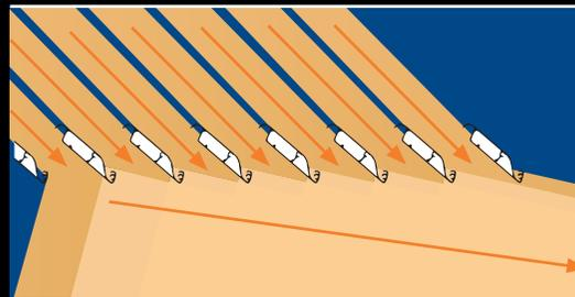
**En hiver** / adossée à la façade, la pergola fera bénéficier d'un ensoleillement indirect à la pièce attenante, avec la réverbération du soleil sur les lames : plus de soleil, plus de lumière, plus d'apport calorifique. Gagnez quelques degrés à l'intérieur en hiver !
