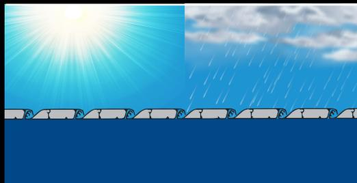
La pergola bioclimatique permet de se protéger du soleil et de s'abriter en cas d'intempéries (pluie, vent, etc.). Ses lames, même entrouvertes, stoppent le rayonnement solaire direct pour une protection optimale. En position fermée, elles bloquent la pluie tout en acheminant l'eau vers les évacuations. Un espace de vie hautement sécurisé !
